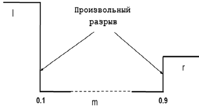
Рис.1. Схематический профиль давления и температуры в начальный момент времени в задаче Вудварда-Колелла
